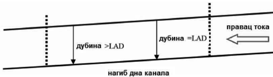
Obrázok 32. Situácia s maximálnym prietokom cez kanál (znížené ústavy)
