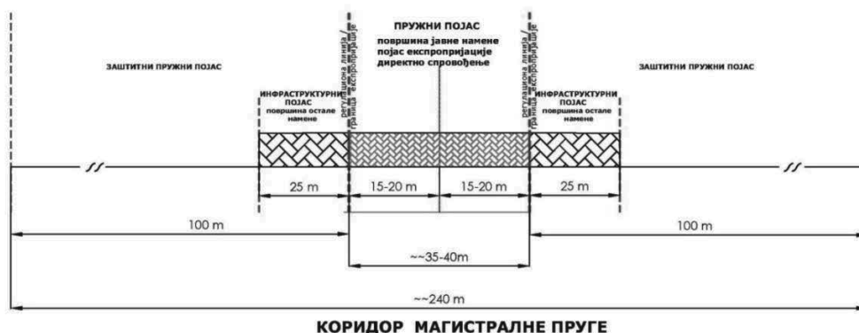
Слика 5: Шематски приказ попречног профила коридора магистралне пруге
